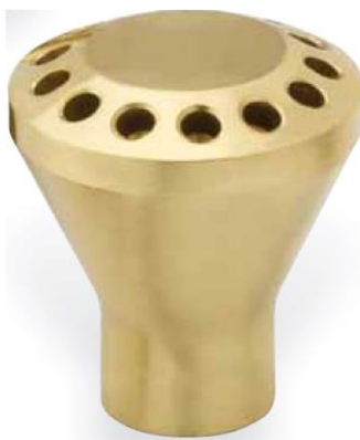
Σχήμα 2: Παραδοσιακός διανομέας μίγματος υγρού - αερίου σε στοιχεία εξατμιστή μετά την εκτόνωση.
